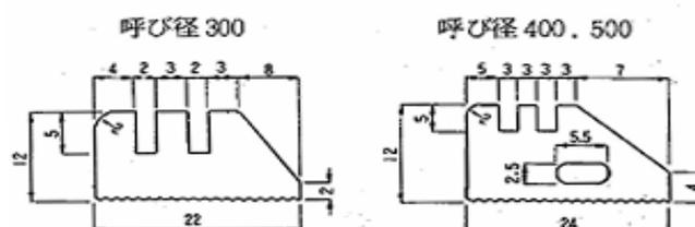
② 連結管に用いるジョイント材は、次の図表に示す材料及び形状のものを標準とする。
