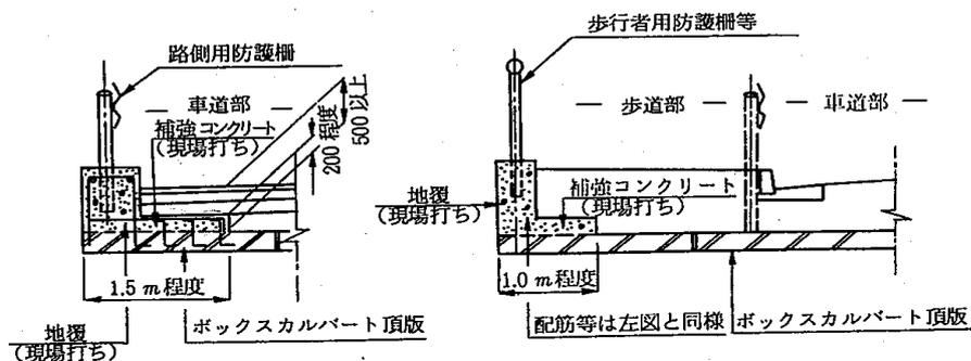
地覆及び補強コンクリートは、現場打ちとするが、頂版との接合部については、差し筋等行い一体化を図るものとする。
