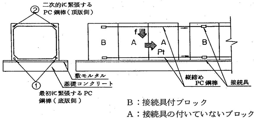
図 1-3-1 緊結施工
