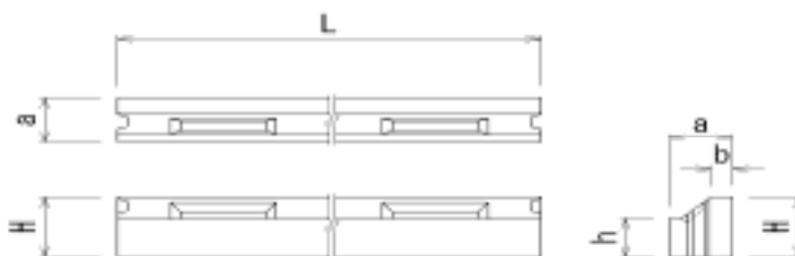
図 2-4 基礎ブロックの形状寸法
